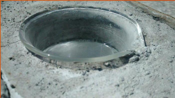
6.- Una vez sacado el agua se toma el peso del prototipo para ver si esta se filtró o se evaporó completamente por el sol.
