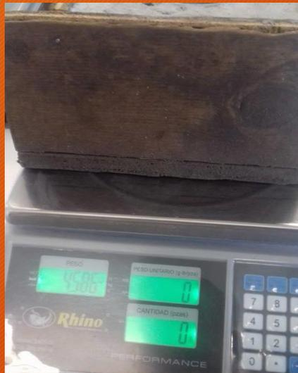
2.- Se agrega 255ml de agua al prototipo para iniciar con el ensayé y también se toma el peso del prototipo con el agua
