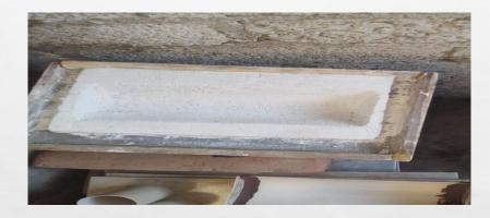
EN EL RECUBRIMIENTO DE YESO CONSISTIÓ EN MOLDEARLO DE UNA MANERA EN QUE SE PUDIERA COLOCAR EL SIGUIENTE MATERIAL QUE ES UN TUBO DE PVC.
