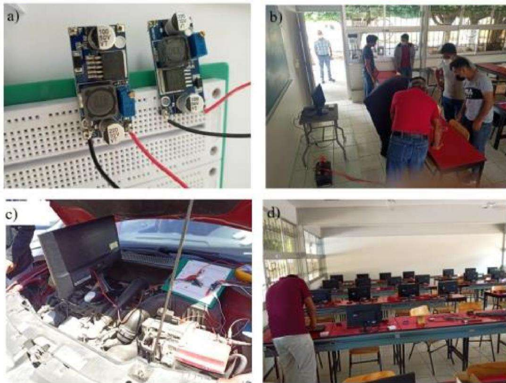
Figura 1: a) Dispositivo electrónico usado para modificar algunas partes de los monitores; b) haciendo las primeras pruebas de un solo componente; c) haciendo pruebas con una batería de automóvil para medir el consumo eléctrico de un monitor; d) 40 computadoras instaladas y funcionando con energía solar.
