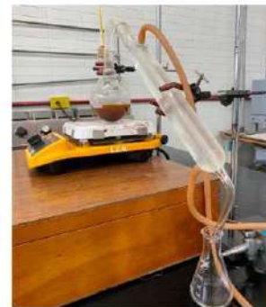
Figura 2. Equipo de destilación.
