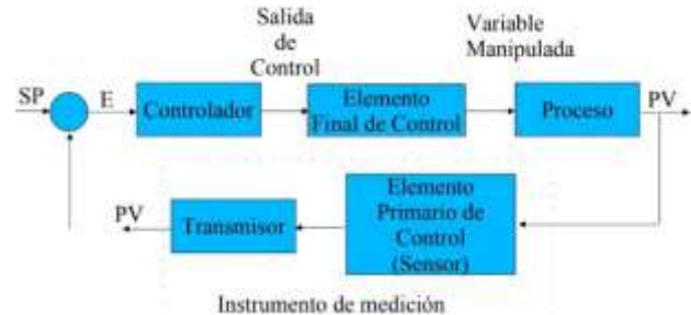
Figura 7. Diagrama de control de lazo cerrado recuperado de, https://ccc.inaoep.mx/~esucar/Clasesrob/control_fundamentals.pdf
