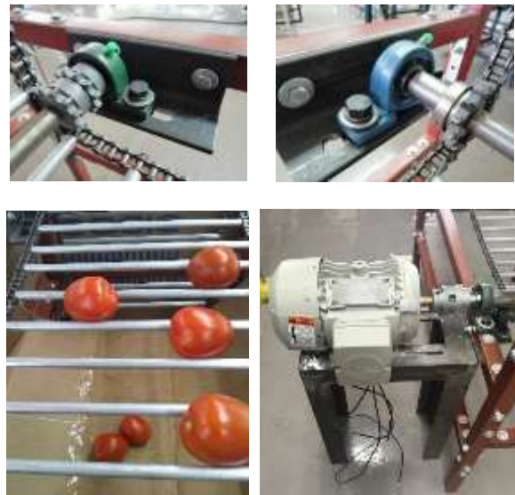
Figura 1. Sistema de transmisión de potencia.
