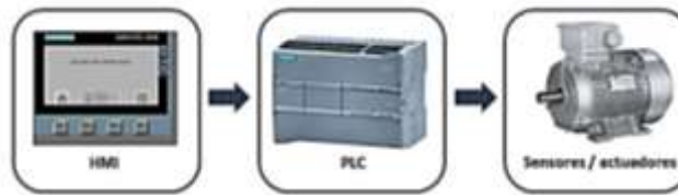
Figura 4. Diagrama de bloque de una interfaz hombre – máquina HMI.
