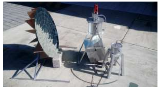
Figura 8. Prototipo de un sistema de evaporación solar a vacío para la concentración del jarabe de agave.
