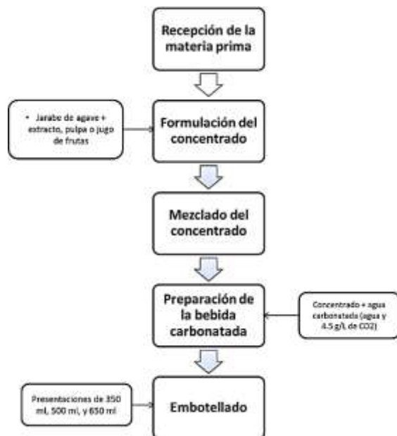
Figura 5. Diagrama de flujo de la obtención de la bebida carbonatada endulzada con jarabe de agave.
