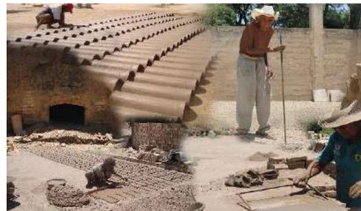
**Figura 3.** Moldeo manual de ladrillos.
