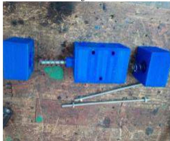
Figura 7. Acople de válvula 5/3 impresa en 3D.
