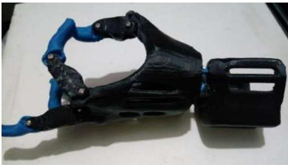
**Figura 3.** Extensión artificial a base de material PLA y PLA FLEX, de mano izquierda, (prototipo ilustrativo).
