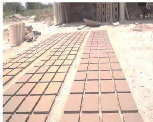
**Figura 4.** Proceso de secado.
