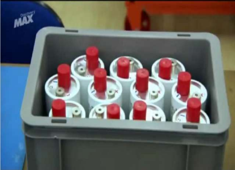
Ilustración 5 Baterías de litio a las cuales se les implementará grafeno en su cátodo, para volverlas hasta 70% más eficientes.
