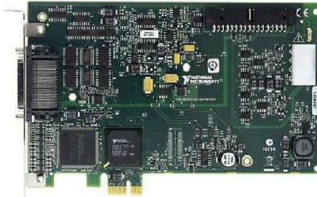
Figura 1. Tarjeta de Adquisición de Datos NI PCIe-6321 Fuente: National Instruments, productos y servicios.
