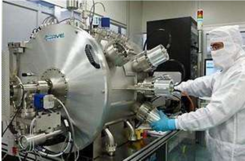
Ilustración 7 Obtención de grafeno mediante el método de CVT.
