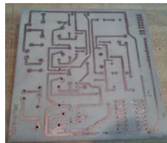
Figura 4. Placa de relevadores
