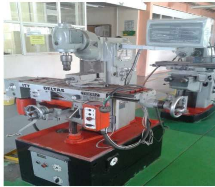
Figura 4 Muestra el Sistema de Control Digital ya instalado.
