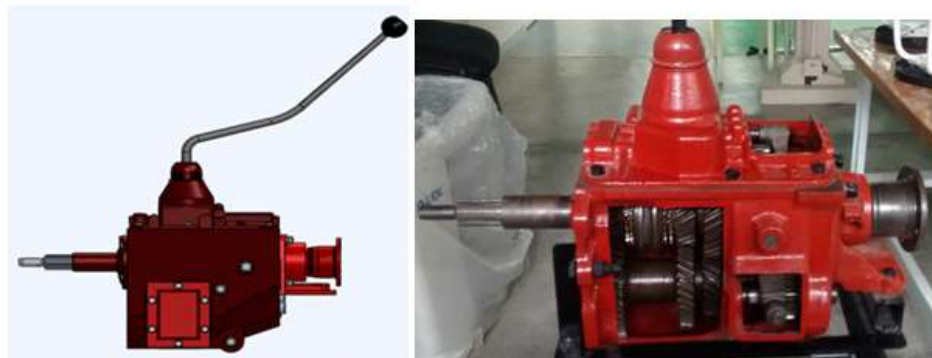
a) Modelo virtual b) Dispositivo físico Figura 3. Caja de velocidades virtual y real.
