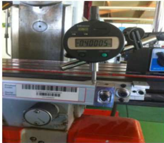
Figura 1 Ilustra la Escala Digital ya montada en la parte frontal de la mesa longitudinal.
