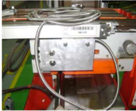
Figura 2 Muestra el montaje y ajuste de la guarda de Protección.
