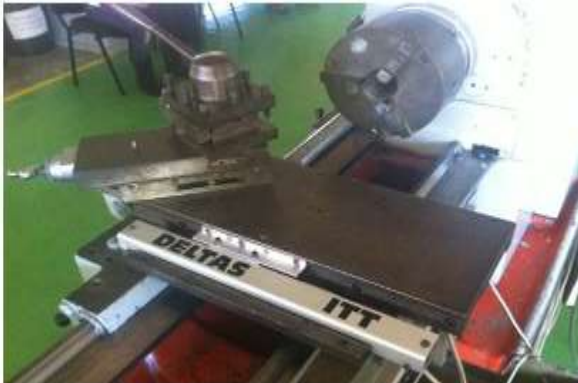
Fig. 2 Muestra las guardas protectoras y los topes.
