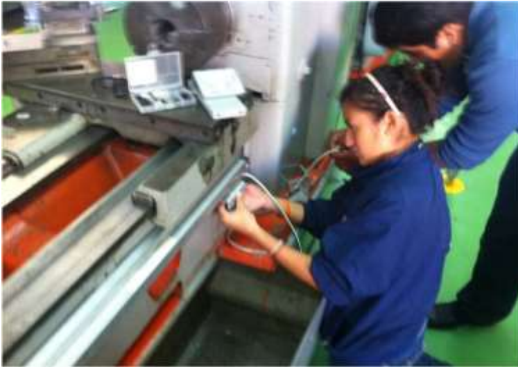
Fig. 1 Montaje de la Escala Digital en la bancada del torno.
