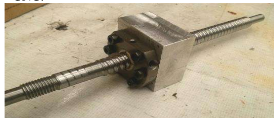
Figura 3. Husillos con tuercas de bolas recirculantes, montados cada eje en barras calibradas de acero bonificado.
