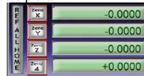
Figura 14. Indicador del origen de la pieza en la interfaz del Mach3Mill
