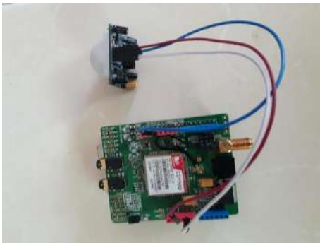
Figura 3. Conexión del sensor PIR al módulo SIM900 con el Arduino Uno.
