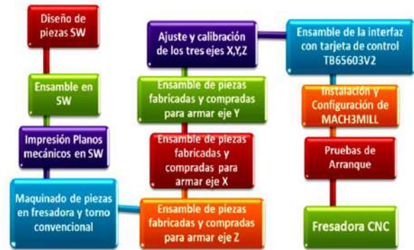
Figura 1. Procesos para la fabricación de la fresadora CNC
