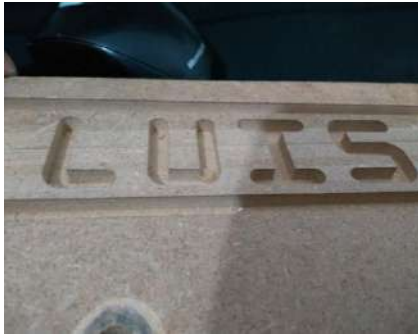
Figura 17. Prueba del funcionamiento de la máquina, con grabado en MDF.
