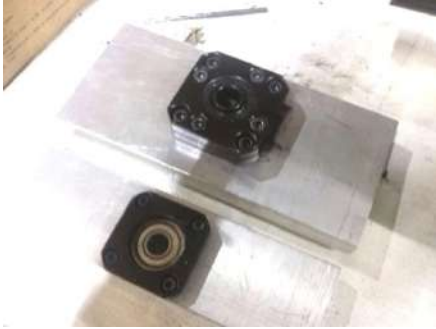
Figura 4. Baleros lineales cerrados con soporte de aleación de aluminio de alta resistencia.
