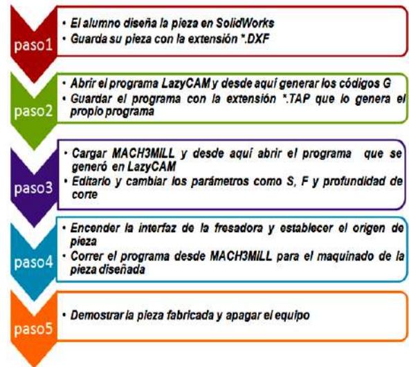
Figura 18. Secuencia lógica para la manufactura de una pieza
