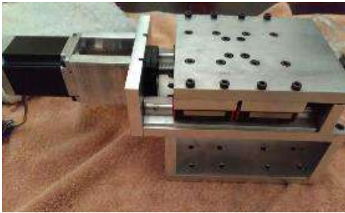
Figura 5. Mesa de fresadora ensamblada.
